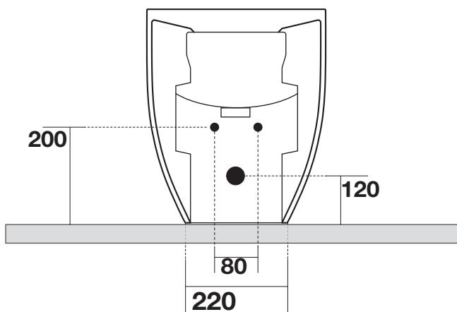
N.B.: Le misure indicate possono subire una variazione dello 0,8 % circa, dovuta ad usura stampi o a piccole variazioni delle caratteristiche tecniche relative alle materie prime che compongono l' impasto.
