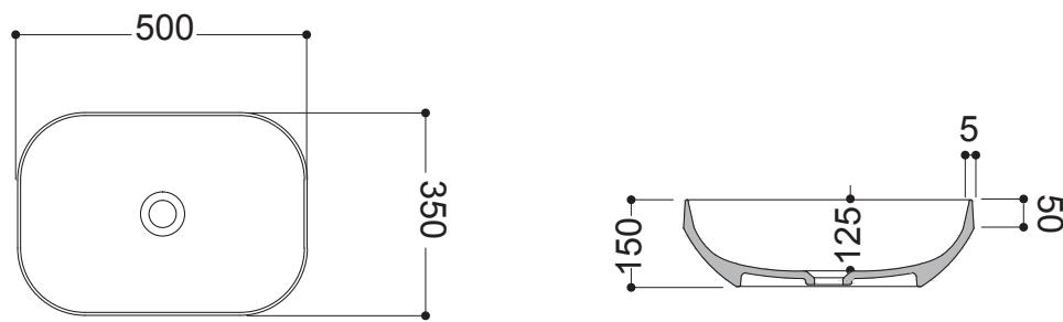
N.B.: Le misure indicate possono subire una variazione dello 0,8 % circa, dovuta ad usura stampi o a piccole variazioni delle caratteristiche tecniche relative alle materie prime che compongono l' impasto.
