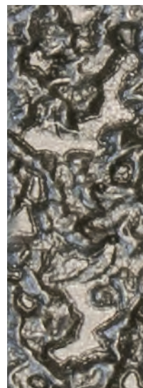
Microgrip erreicht eine Rutschhemmung der Klasse R11 gemäß DIN 51130
