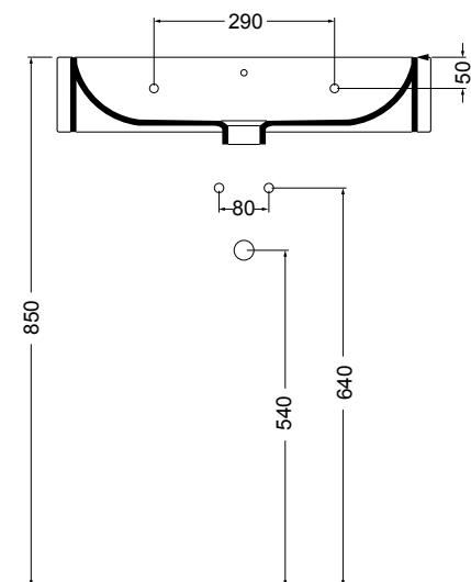
N.B.: Le misure indicate possono subire una variazione dello 0,8 % circa, dovuta ad usura stampi o a piccole variazioni delle caratteristiche tecniche relative alle materie prime che compongono l' impasto.
