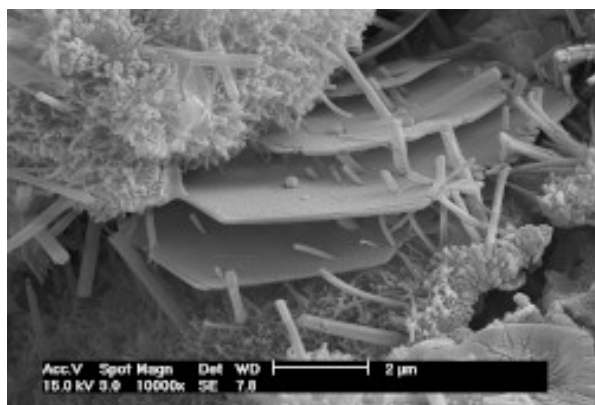
Hidratacija veziva na bazi portland cementa u tradicionalnoj masi za fugovanje.
